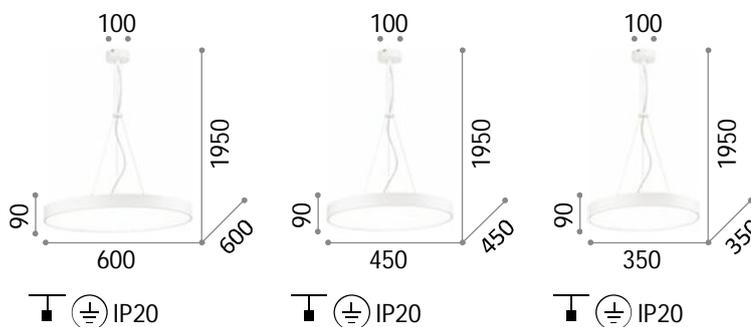
7,100 Kg / 0,0583 m~ LED 44W / 4300/5000 Lm    4,930 Kg / 0,0329 m~ LED 31W / 2800/3200 Lm    3,250 Kg / 0,0194 m~ LED 25W / 2200/2500 Lm
